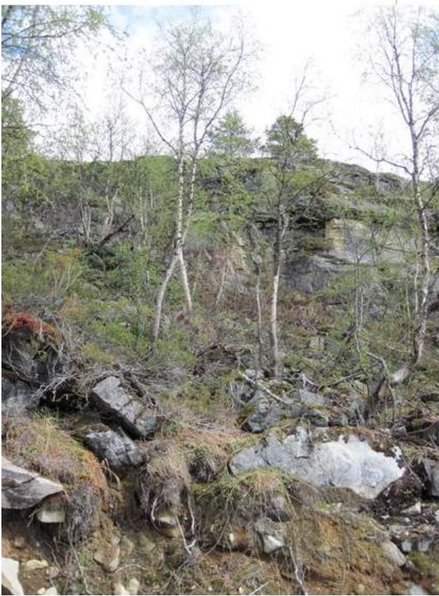
Bilde 9: Tverrgående åpne sprekker i fjellveggen.
